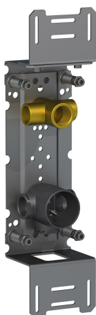
4300 Robinet électronique système mains libres. (bec placé à 120 mm de l'axe de la cellule).Alimentation du robinet : 1/2. Sortie du bec : 3/4.La boîte étanche doit être placée dans un endroit accessible et à une distance max de 1100 mm de la partie encastrée.
